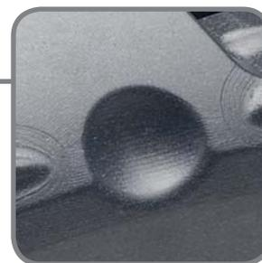
Dettaglio della lavorazione dal pieno per alleggerimento corpo pinza. Detail of billet processing to reduce caliper body weight.
