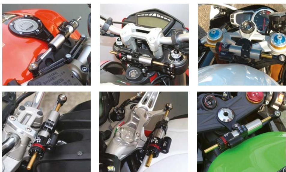
Set kit di montaggio specifici per i vari modelli di moto, ricavati dal pieno in lega di Alluminio Al 7075 con trattamento di ossidazione anodica (forniti completi di viteria, non richiedono modifiche per il montaggio).
